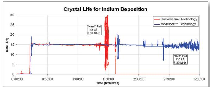
如此处图中所示，在铟沉积中，INFICON Modelock测量技术显著延长了晶体寿命。
