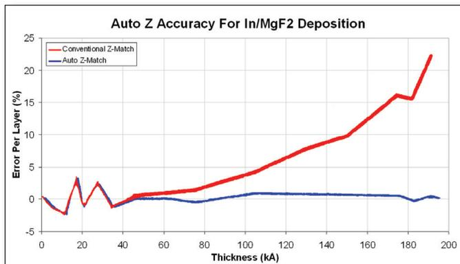
Auto-Z功能大大提高了多种材料和多层的厚度测量精度。
